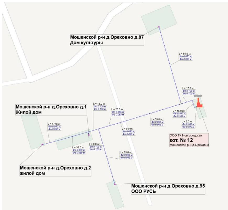
Рисунок 6 – Схема тепловых сетей котельной №12 д. Ореховно
