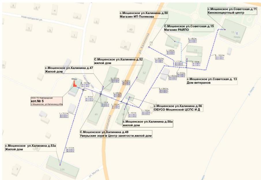
Рисунок 2 – Схема тепловых сетей котельной №5, с. Мошенское, ул. Калинина, д. 49а
