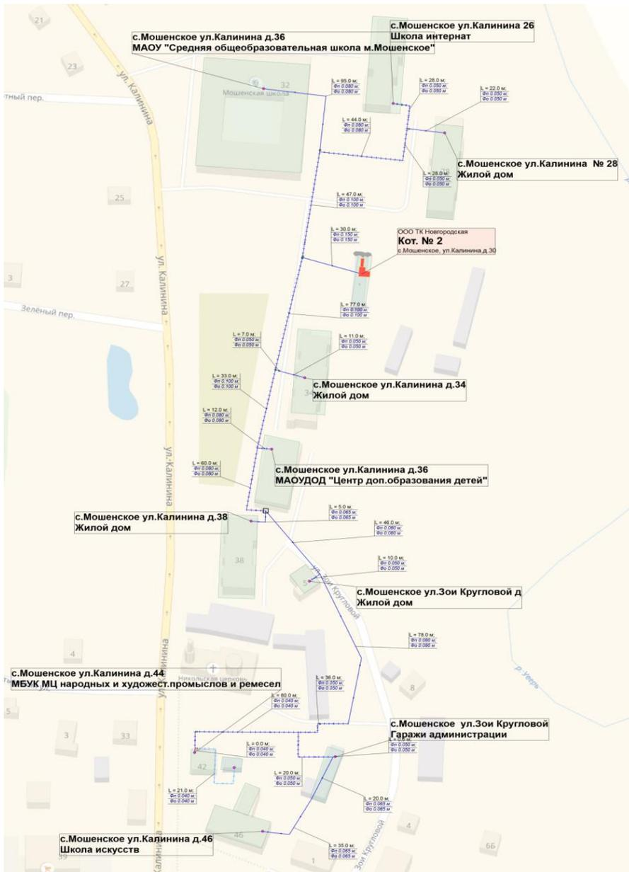
Рисунок 3 – Схема тепловых сетей котельной № 2, с. Мошенское, ул. Калинина, д. 30
